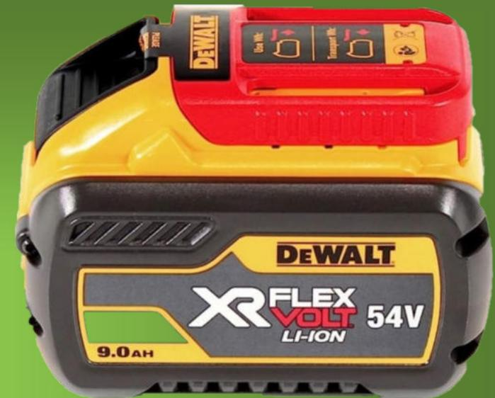
Versenden **nur mit roter Kappe** ! Die Batterietransportkappe trennt die Zellstränge, so dass die Batteriepack-Baugruppe während des Transports als drei Batteriepacks klassifiziert werden kann. Alle 54V XR FLEX VOLT Akku's von DEWALT sind so konzipiert.
