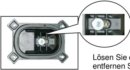
Lösen Sie dazu die Innensechskantschraube und entfernen Sie diese.
