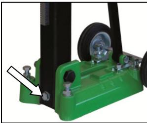
Entfernen Sie die Schraube welche die Bohrsäule bei 90° arretiert.
