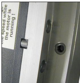
Dit gereedschap wordt geleverd met een montageplaat, een 10 mm plaatsingssleutel en 4 inbusbouten M8x20. De montageplaat wordt op de boormotor gezet met de plaatsingssleutel en bevestigd met de 4 bouten. Let op de montagerichting.
