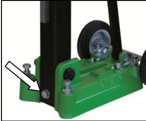
Nach dem Bohren ist die Säule wieder in die 90° Position zu bringen.
