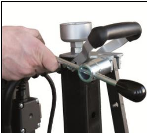
Öffnen Sie mit dem Drehkreuz die obere Schraube der Abstützung und entfernen Sie diese.
