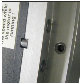
L'outil est fourni avec un support de montage, une clé de 10mm et 4 vis Allen M8x20. Le support de montage est placé sur la carotteuse avec la clé et fixé au moyen des 4 vis.
