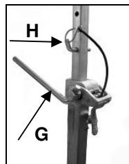
Positionnez le support. Positionnez la colonne de serrage rapide le plus près possible de la colonne sur la base. Fixez le support en tournant la manivelle (G) dans le sens des aiguilles d'une montre. Sécurisez l'ajustage avec le boulon approprié (H).
