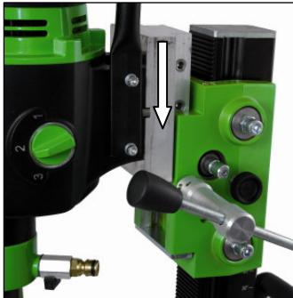
De montageplaat wordt op de boormotor gezet met de plaatsingssleutel en bevestigd met de 4 bouten.
