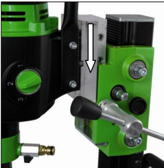
Die Montageplatte wird mit der Passfeder so auf die Maschine aufgesetzt, dass sich die Buchsen in der Montageplatte auf der gleichen Seite befinden wie die Getriebeumschaltung der Maschine. Danach werden die vier Schrauben eingesetzt und fest angezogen.
