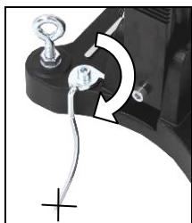
Markieren Sie die Mitte der zu erstellenden Bohrung.
