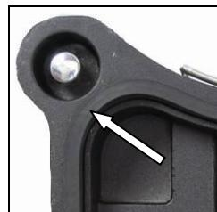
Beachten Sie bitte, dass die Nivellierschrauben so eingestellt sind, dass sie nicht aus der Unterseite des Bohrständers herausragen, da sonst das Vakuum beeinflusst wird und der Ständer sich vom Untergrund lösen kann.
