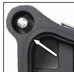
Veuillez vous assurer que la vis de nivelage est ajustée de sorte qu'elle ne dépasse pas du bas de la base, au cas contraire la mise sous vide sera compromise et l'installation pourrait se détacher de la surface de montage. Lorsque vous branchez une pompe à vide d'une puissance suffisante (min. – 0.8 bar), assurez-vous que les joints ne sont pas usés.
