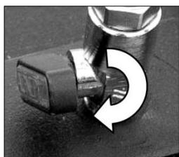
Do demontażu mocowania próżniowego, zamknąć zawór kulowy. Spowoduje to otworzenie zaworu napowietrzającego, przez co wyrówna się ciśnienie w podstawie z ciśnieniem atmosferycznym. W razie potrzeby można w ten sposób przestawić statyw przy pracującej pompie próżniowej.
