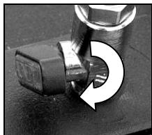
De klep sluiten om de vacuümkoppeling los te maken. Dit opent de ontluuchtingsklep waardoor het vacuüm kan ontsnappen.
