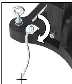
Markeer het midden van gat dat moet worden geboord. De centreringsindicator maximaal verlengen (zie afb.). De boor zodanig positioneren dat de punt van de indicator precies op het boorgat staat. Als de boor is vastgezet, de centreringsindicator weer terugbrengen in de originele stand.
