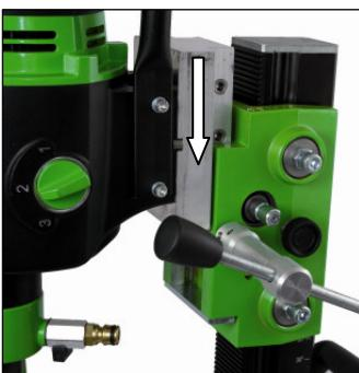
Wsunąć silnik z zamocowaną płytą montażową do statywu i zablokować jego położenie przy pomocy pokrętła posuwu.
